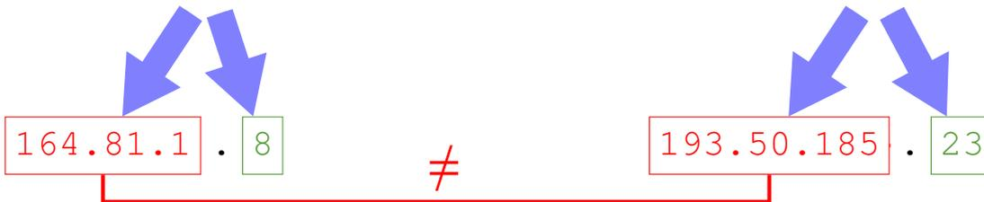
Les identifiants réseaux sont différents ⇒ Routage indirect ⇒ passage par le Routeur.
